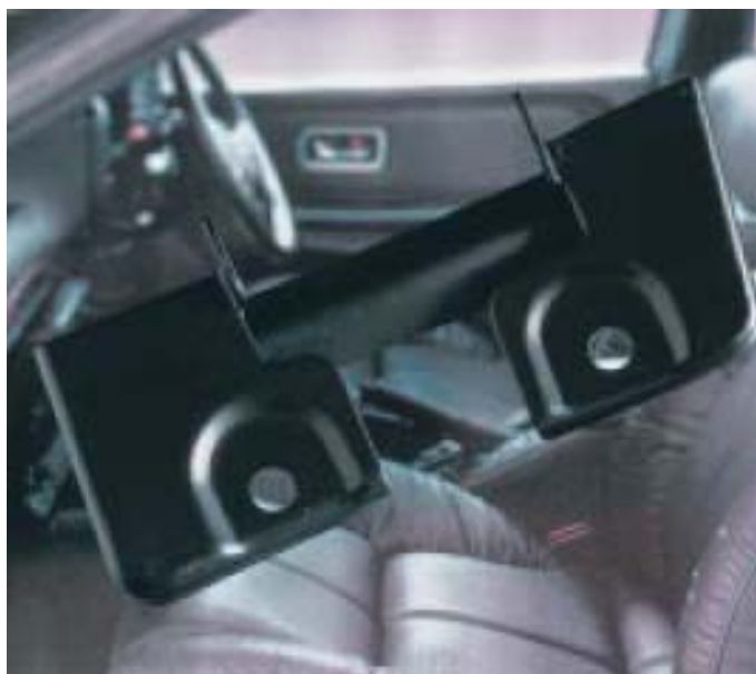
Wspornik kolumny pasa bezpieczeństwa pokryty Xylan'em pomaga zapewnić bezpieczeństwo.
